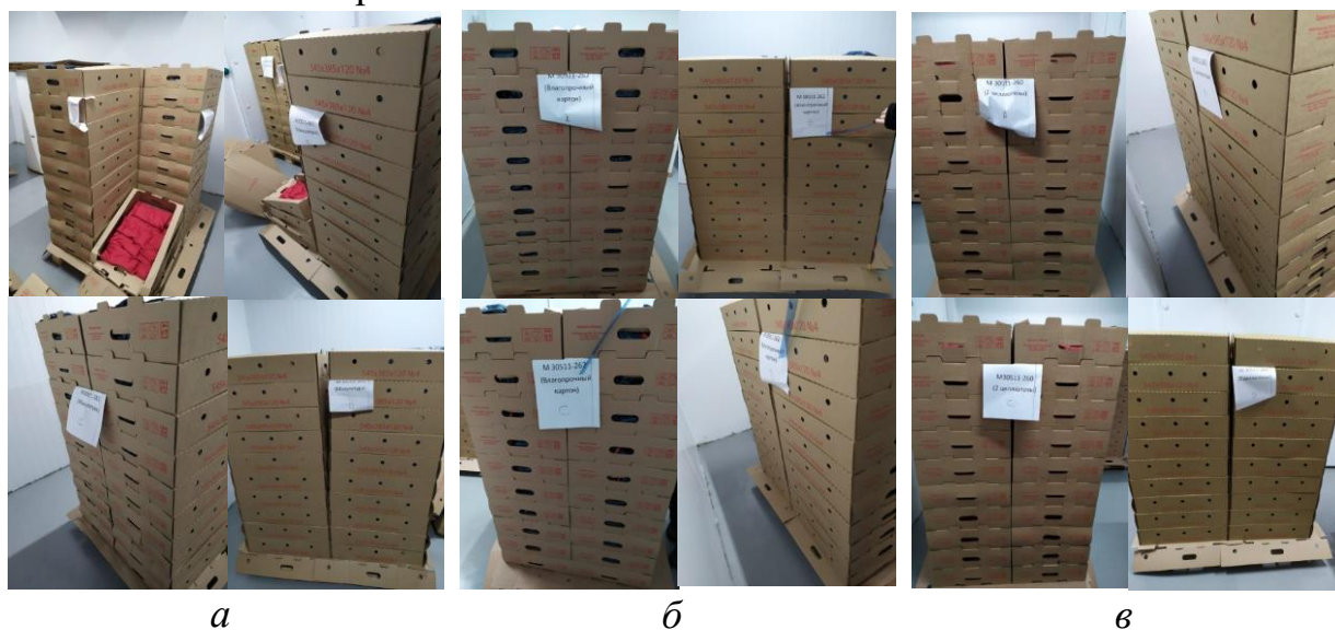
Рис. 1. Устойчивость штабеля при хранении в климатической камере в течение 64 часов: a – стандартное макулатурное сырье, б – влагопрочное макулатурное сырье, в – целлюлозное сырье.
