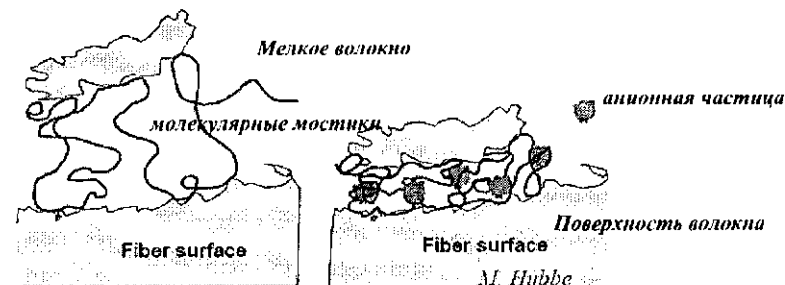
Рис. 3. Механизм действия микрочастиц в присутствии волокон
